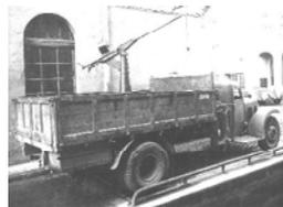
Ilustração 23: Caminhão modelo T-69, movido a gasogênio, com canhão antiaéreo Hispano-Suiza
